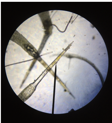
AFB. 2-03 Microscopisch beeld van brandharen (40 keer vergroting). Het zwarte aanwijsstokje van de microscoop raakt net de naar rechts omhoogstekende haar, die scherp zichtbaar is. Daarachter, naar beneden wijzend, liggen nog twee andere haren waarvan alleen de contouren te zien zijn.
